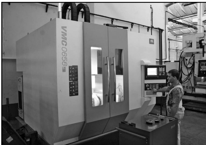
Máquina de centro mecanizado de cinco ejes, uno de los equipamientos adquiridos dentro de la inversión.
