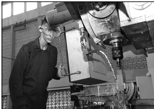
Fresadora CNC, una de las ocho máquinas herramientas modernizadas en la planta.
