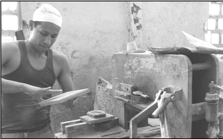
En la fábrica de Guanabacoa un joven operario elabora mosaicos para pisos, pasos de escaleras, rodapiés y otros surtidos, en un proceso artesanal.
