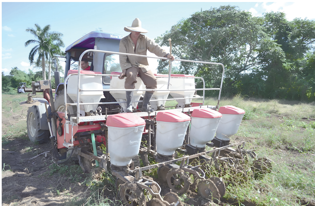
Una máquina en forma de araña fertiliza y siembra a la vez.
